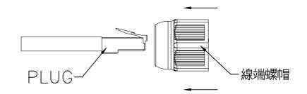
1. 將線端螺帽依圖示方向, 套入已組裝完成的PLUG中.
