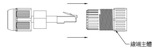
3. 請依圖示方向, 先將PLUG穿過線端主體, 再將防水環推至線端 主體底部, 最後將線端螺帽預鎖上線端主體即可.
