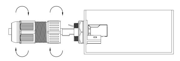
2. 請圖示先將線端主體和防水盒端旋緊, 再將盒端螺帽和防水盒端旋緊即可.
