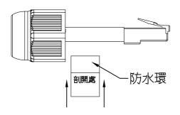
2. 將防水環的剖開處依圖示方向套上已組裝完成的CABLE.
