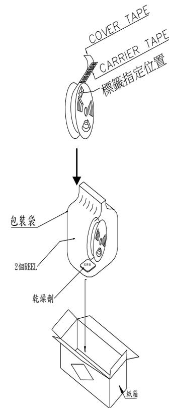
1. CARRIER TAPE 須預留 160mm 長(約 10 個 Pitch 槽孔), 才可擺入成品, COVER TAPE 亦同。
