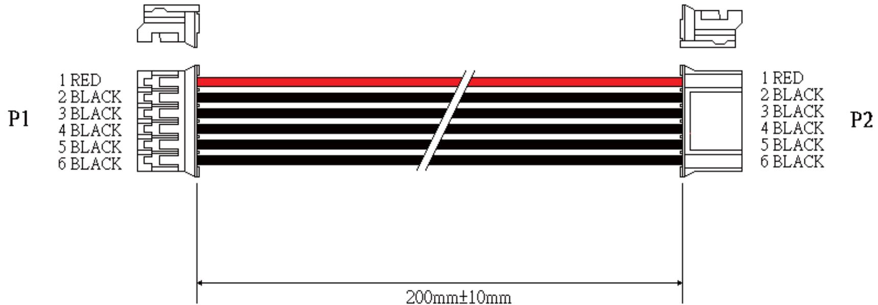
1. P1,P2 : 2.0mm PITCH CRIMP TERMINAL AND HOUSING PH-H-06 COLOR=WHITE
