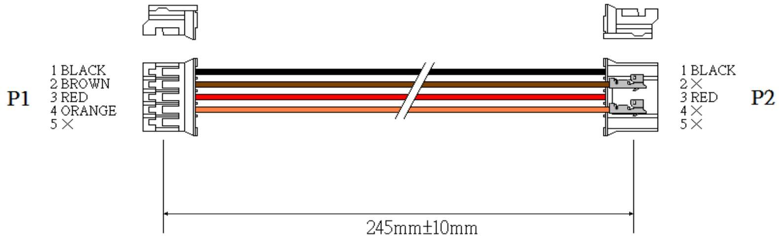
1. P1,P2 : 2.0mm PITCH CRIMP TERMINAL AND HOUSING PH-H-05 COLOR=WHITE
