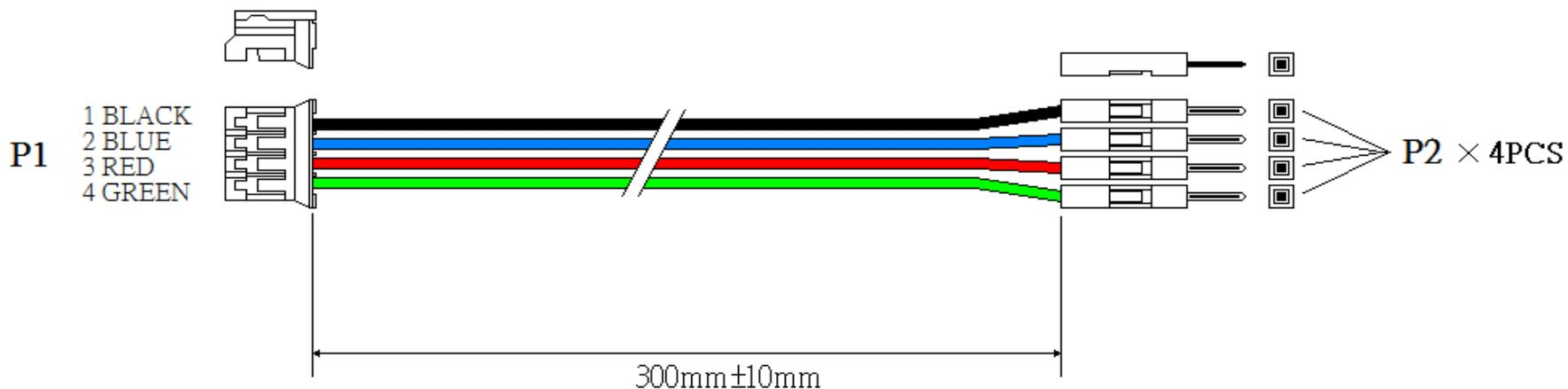
1. P1 : 2.0mm PITCH CRIMP TERMINAL AND HOUSING PH-H-04 COLOR=WHITE
