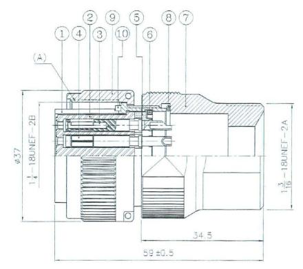
註一 (A)處固定帽塗抹I/4圈鋰基滑脂 GREASING ON THREAD PART ABOUT 1/4
